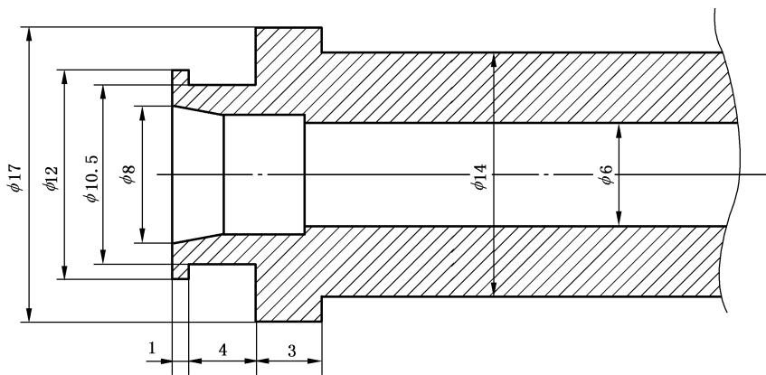
图 A.2 调压器进口手轮连接接头
