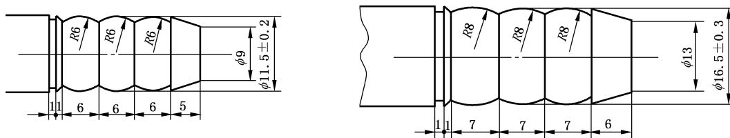
图 2 调压器出气口软管接头
