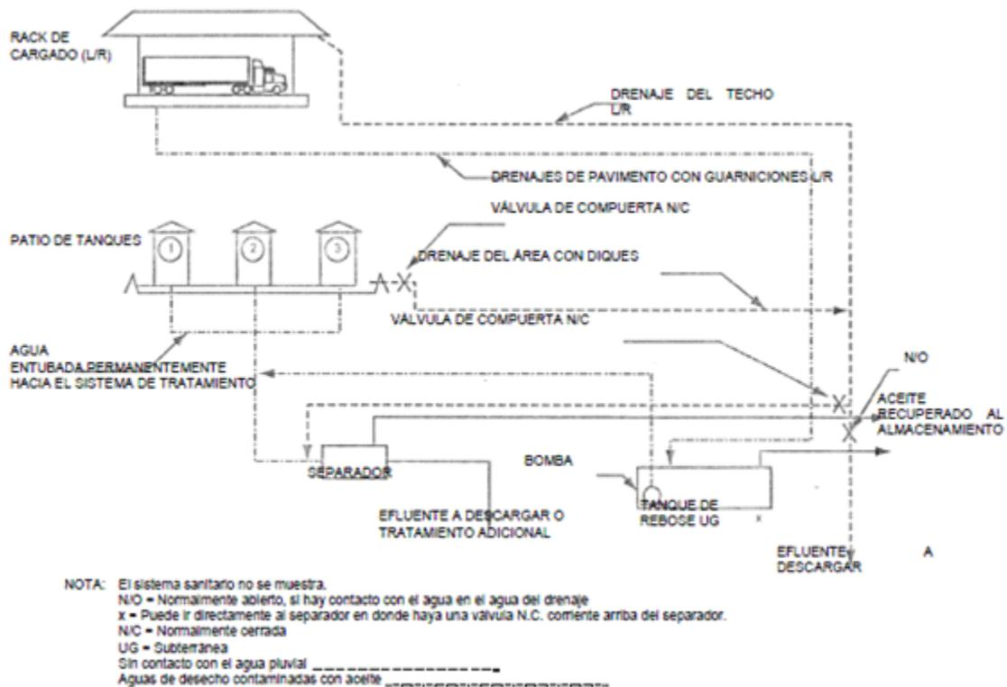
Figura 10. Sistema de Drenaje pluvial y aceitoso
