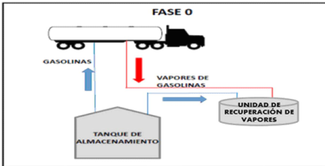
Figura 13. Fase 0 del Sistema de Recuperación de Vapores
