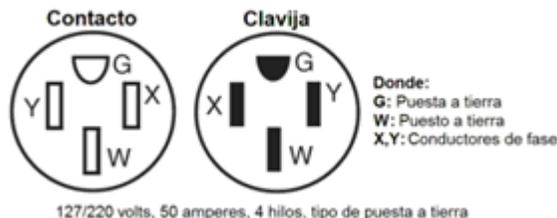
**Figura 550-10 (c).- Configuraciones de contacto y clavija de 220Y/127 volts, 50 amperes, 3 fases, 4 hilos, con conductor puesto a tierra, para uso con cordones de alimentación en casas móviles y sus estacionamientos**
