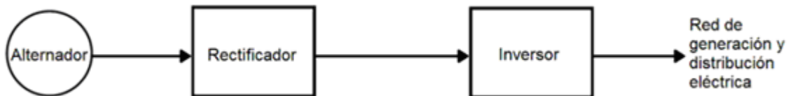
Figura 694-1(a).- Identificación de componentes de un sistema eólico - sistema interactivo.
