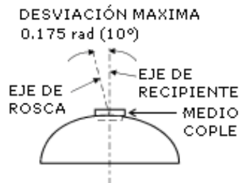
Figura 15-Concetricidad y desviación del medio cople con el recipiente
