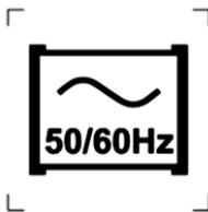
รูปที่ 2 หลอดที่เหมาะสมกับการทำงานที่ความถี่ 50 Hz หรือ 60 Hz
