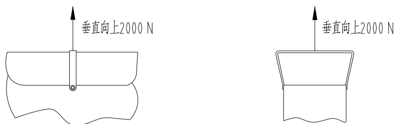
图 A.1 拉带装置拉力试验示意图
