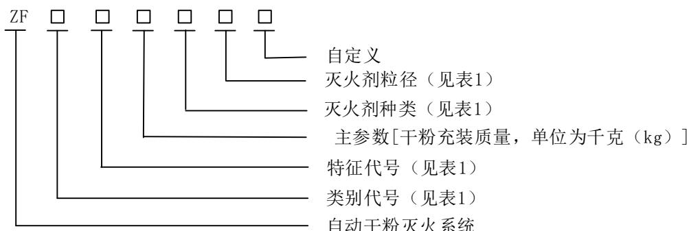
示例 1：ZFP1500A 表示贮气瓶型干粉灭火系统，充装 ABC 普通干粉灭火剂，干粉灭火剂质量 1 500 kg。
