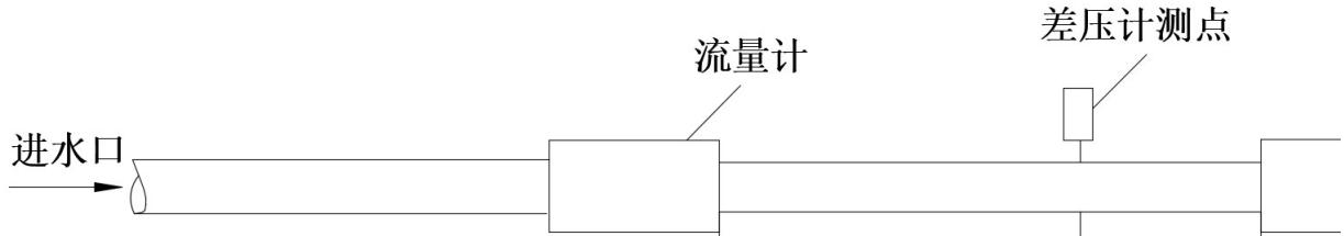
图2 等效长度试验装置
