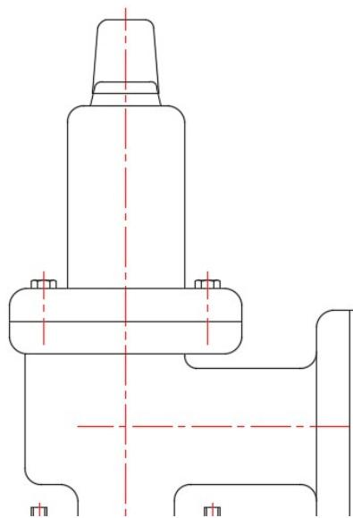
图 1 安全阀密封试验布置图
