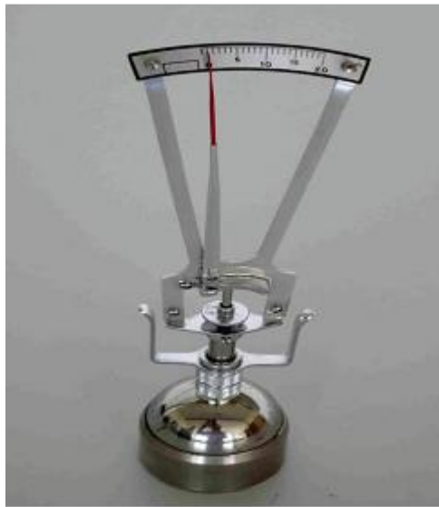
Figura 5 – Tonómetro de impresión colocado en el bloque de pruebas, indicando 0,0 en la escala
