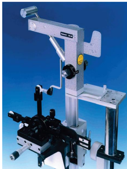
Figura 3 – Vista detallada de la instalación de prueba del tonómetro de aplanamiento (usando una balanza)
