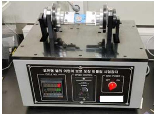
그림 A10. 비틀림 시험 장치 예시
