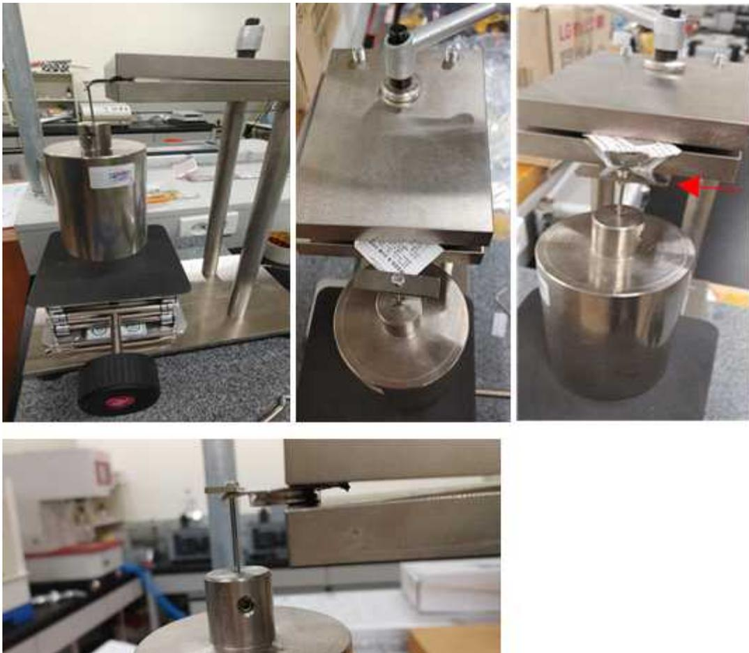
그림 A12. 누름 시험 장치 예시
