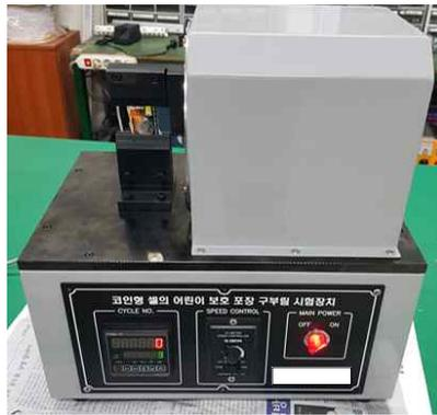
그림 A7. 구부림 시험 장치 예시
